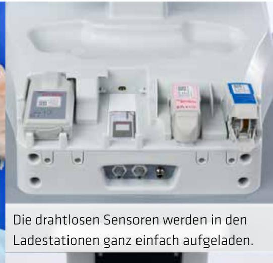
Die drahtlosen Sensoren werden in den Ladestationen ganz einfach aufgeladen.
